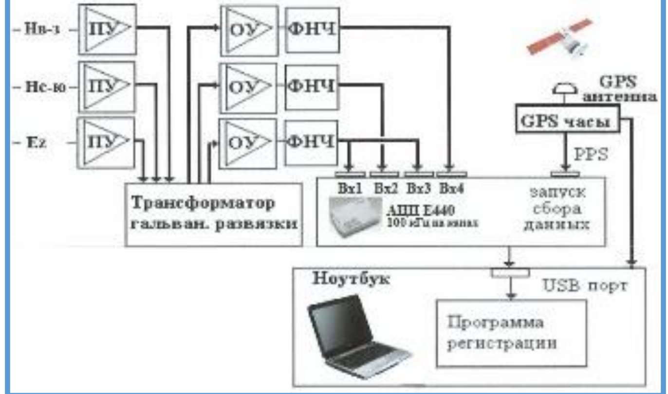
Блок-схема однопунктового грозопеленгатора-дальномера.
