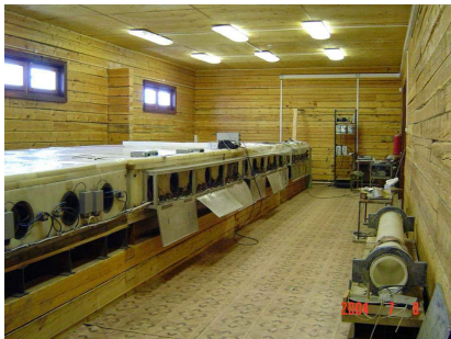
Рис. 2: Супернейтронный монитор 24-NM-64 в здании Якутского спектрографа КЛ
