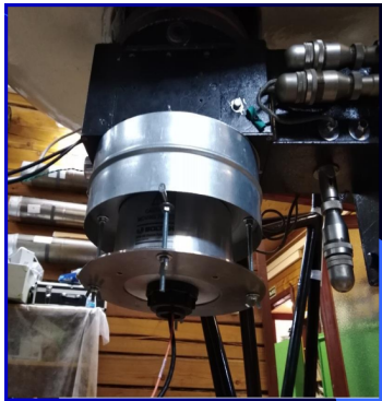
Рис. 6: Приставка для восстановления работоспособности ионизационной камеры АСК-1. Сенсорный блок на основе датчика атмосферного электрического поля Boltek EFM-100. [Из доклада н.с. к.ф.-м.н. Торопова А.А. на 36-й ВКЛ]
