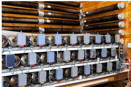
Рис. 8: Мюонные телескопы на пропорциональных газоразрядных счетчиках СГМ-14
