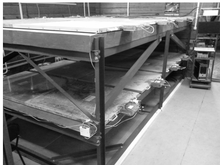
Рис. 9: Мюонные телескопы на сцинтилляционных счетчиках СЦ-301 производства ИФВЭ
